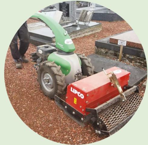
Désherbeur mécanique sur cellule
