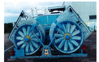
S21 - Pulvérisateur simple, double ou 4 hélices, voûte orientable
